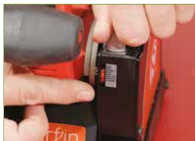
Réglage de la profondeur avec index
