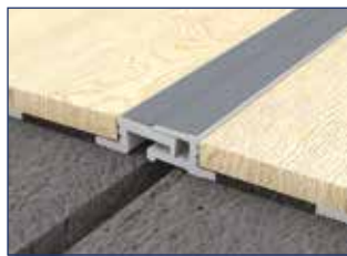
1 - Utilisation si joint dans le béton de 5 à 8 mm maxi.
