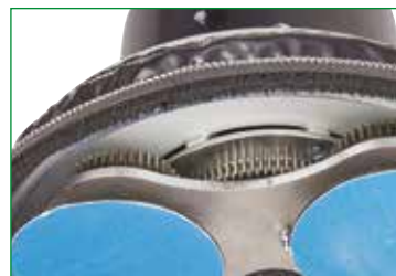
Système d'entraînement des disques avec engrenage métallique.
