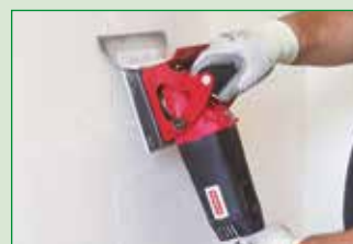
Dépose au mur (inverser la lame)
